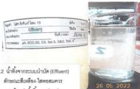
3.1 สภาพน้ำทิ้งระบบออกซิเจนชีวภาพ ลักษณะสีเหลืองขุ่นขาว, มีตะกอนละเอียด
