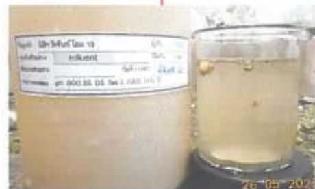
1.2 น้ำเสีย ที่เก็บตัวอย่างจาก (บ่อเก็บเกรอะ) สภาพน้ำเน่าเสียจาง-ขุ่น
